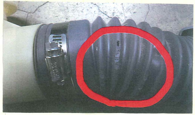
排水のゴム製ジャバラ管に、無数のキズと穴。
